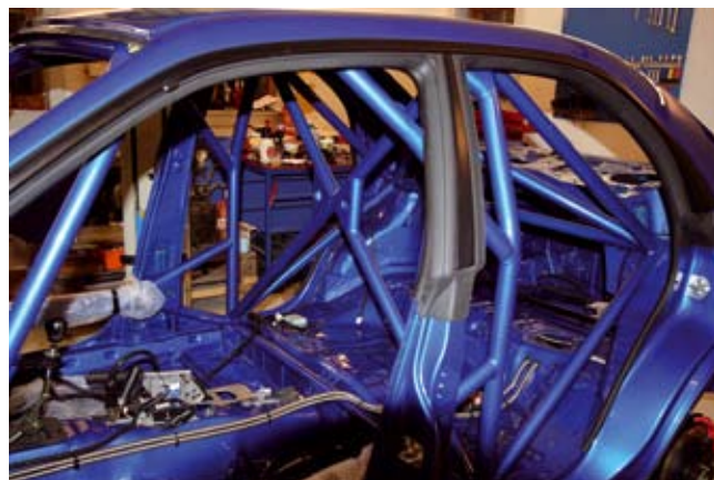
Det blir lagt stor vekt på sikkerhet med stag på kryss og tvers
